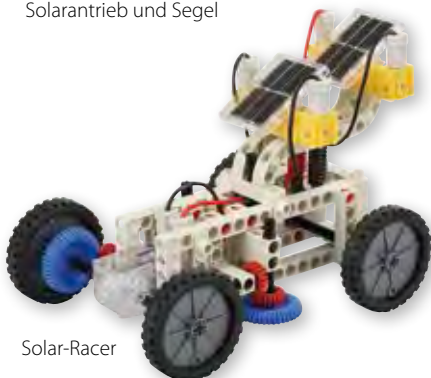
Kombi-Fahrzeug mit Solarantrieb und Segel
