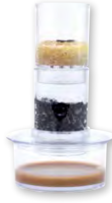
minimaler zweistufiger Filter mit Sand und Aktivkohle
